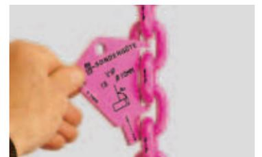
Comprobación del alargamiento del paso del eslabón por desgaste del diámetro nominal.
