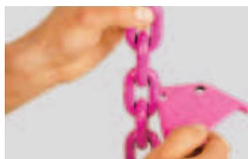
Comprobación del desgaste del diámetro nominal del eslabón.
